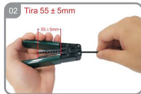
Descasque a camada do cabo
